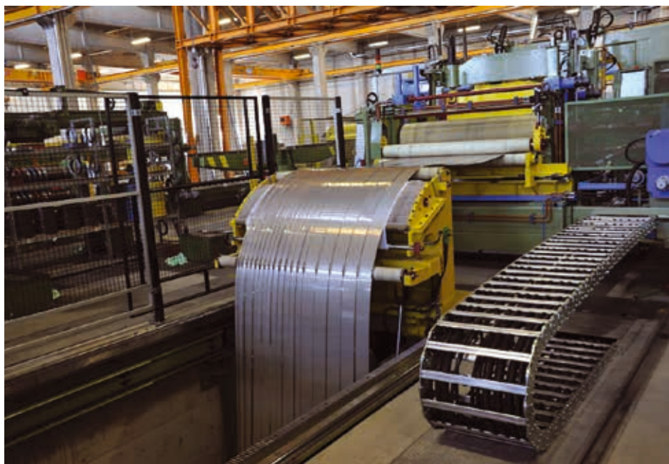
Fase di lavorazione di prodotti piani in acciaio inossidabile
